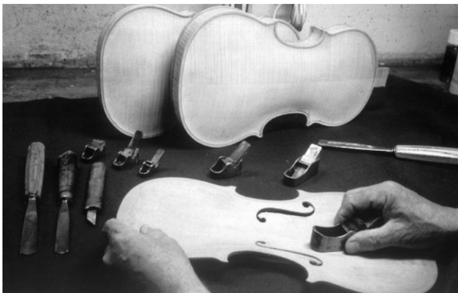
Afaïçonament de la tapa harmònica.
